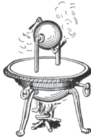
Figura 1. Eolípila, primera máquina a vapor. Fuente: [2]
